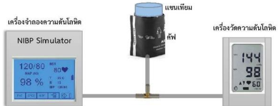
รูปที่ 1 แสดงการประกอบอุปกรณ์ สำหรับการสอบเทียบเครื่องวัดความดันแบบพลวัตและอัตราชีพจร
